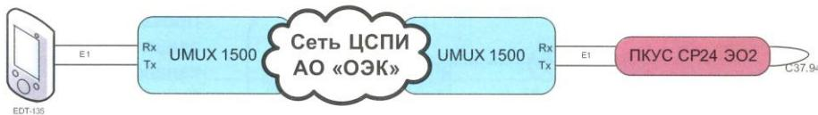
**Рис. 5.а.** Измерение каналов связи для РЗ. Этап 2 (вариант а).
