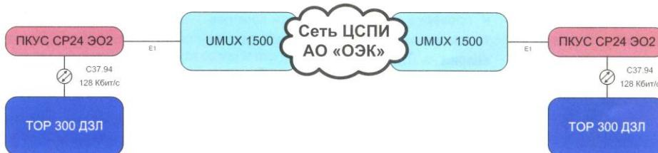
**Рис. 6.** Измерение каналов связи для РЗ (этап 3)
