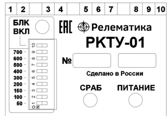
Рисунок 2 – Общий вид лицевой панели реле РКТУ-01
