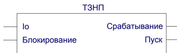
Рисунок 1.2.3 – Обозначение ступени ТЗНП
