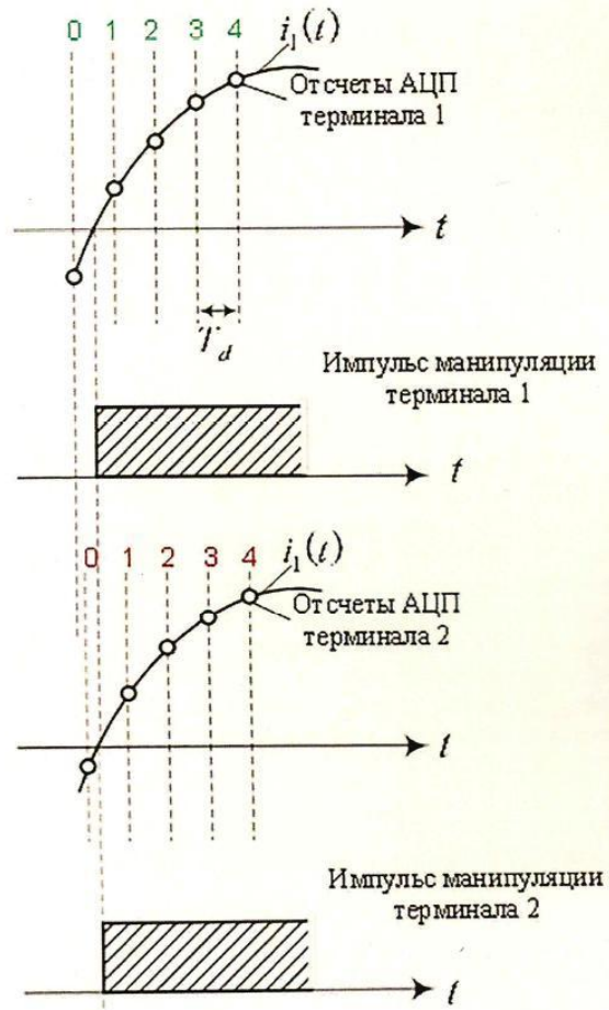
Рисунок 1 – Манипуляции полукомплектов традиционной ДФЗ при подаче одинаковых сигналов тока
